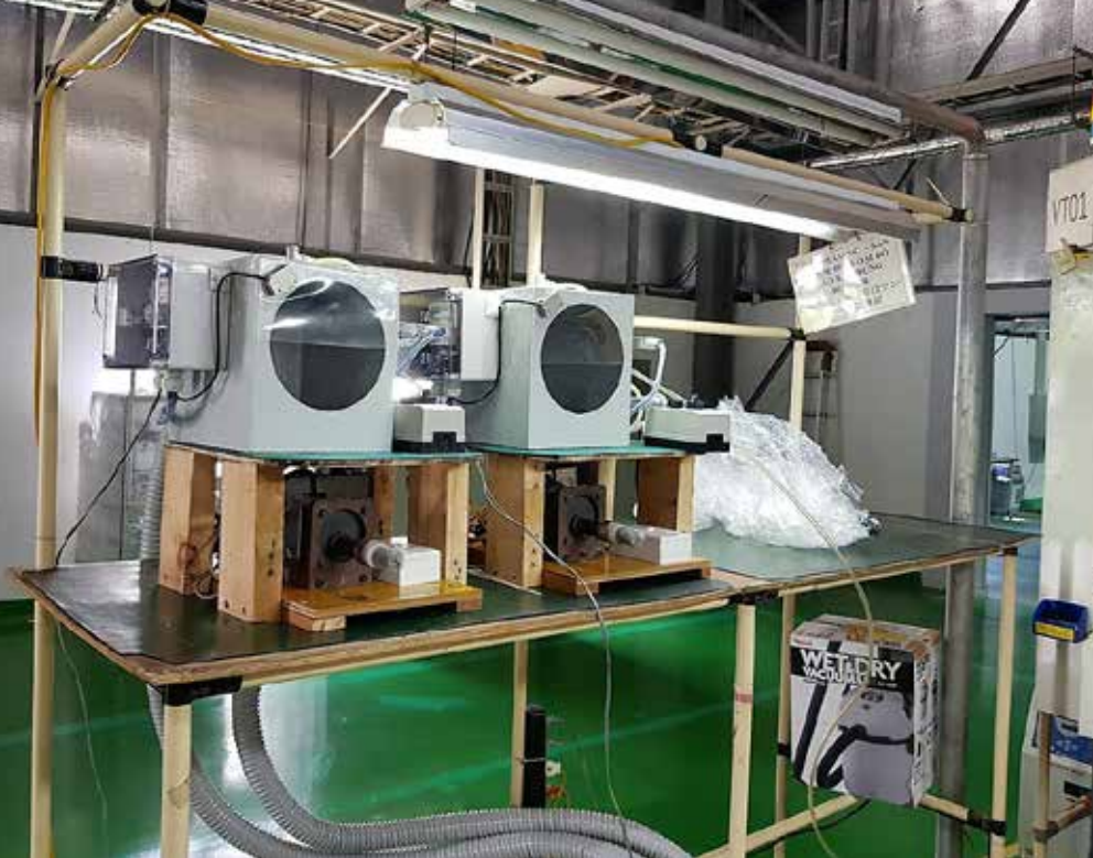
▲真空バキューム集塵装置
