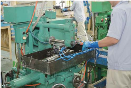
ペンチの鍛造品を切削加工
