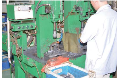
ペンチの鍛造品を穴明け加工
